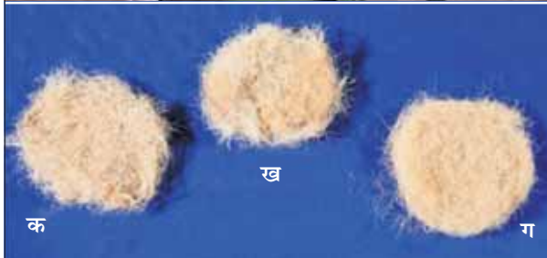
नारियल रेशा विलगक मशीन (ऊपर) और विलगित नारियल रेशे - क. अलग किये रेशे, ख. अविलगित रेशे (देर), ग. विलगित महीने रेशे
