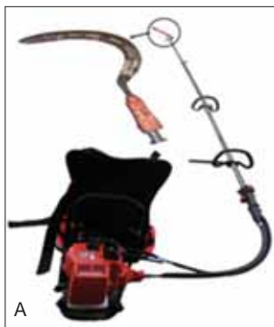
(अ) बैक पैक मॉडल-तेलताड़ के गुच्छों को तोड़ने का यंत्र (ब) मोटर चालित गुच्छा तोड़ने वाली मशीन का मूल्यांकन
