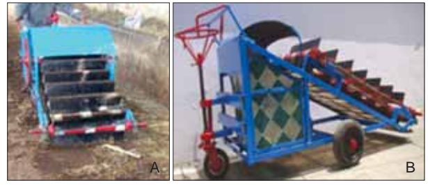
(अ) पेट्रोल इंजन चालित गोबर-एकत्रक मशीन, (ब) विद्युत मोटर चालित गोबर एकत्रक मशीन
